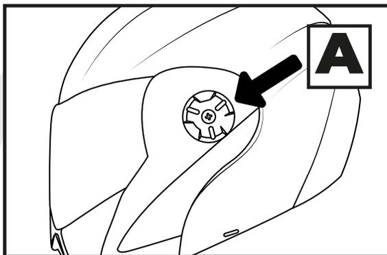
Ubíquese en el punto (A) y utilice un objeto plano para girar hacia adelante 90° el tornillo, realice este proceso en ambos lados y retire el visor halando hacia afuera, para ponerlo nuevamente ubique el visor en la posición inicial e inserte el tornillo y con ayuda de un objeto plano gírelo hacia atrás 90°.
